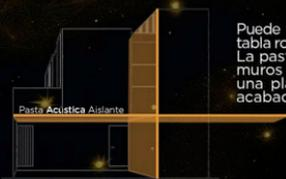
Puede ser instalada sobre superficies de tabla roca o concreto. La pasta se aplica en la superficie de los muros o el techo y sobre ella se coloca una placa de tabla-roca o duro como acabado.
